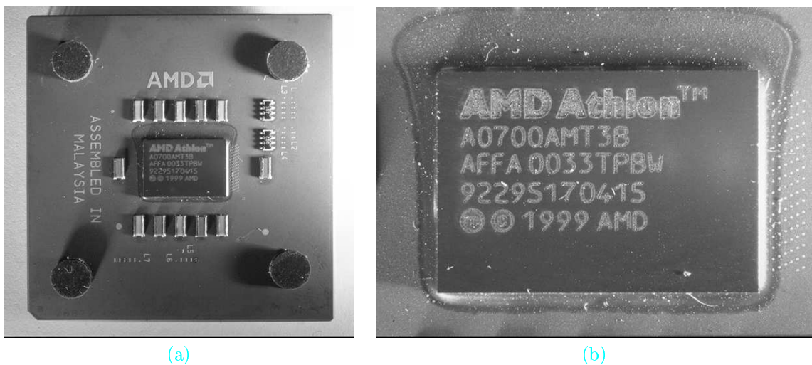
FOTO 3.3: (a) El microprocesador K7 de 0.18 micras, que cuenta ya con una caché L2 integrada de 256 Kbytes. (b) Detalle del área de integración donde se encuentra esta caché.
