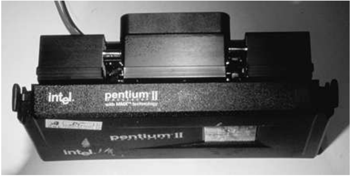
FOTO 5.1: El microprocesador Pentium II envuelto en su cartucho cerámico SECC y con su disipador de calor y ventilador acoplado por la parte superior.
